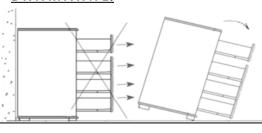
Рекомендуется крепить к стене дюбелями (в комплект не входят), выполнив дополнительно отверстия в бруске заднем поз.5
